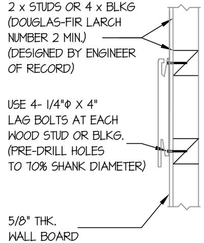
SIDE ELEVATION AT WOOD STUD WALL
